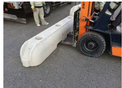
③リフト掬上状況
